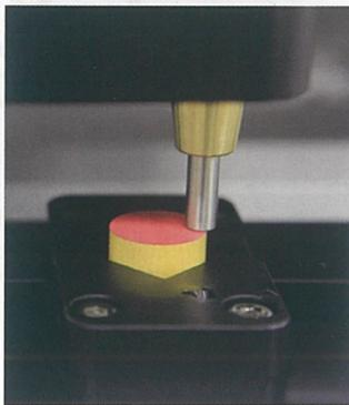
さを計測し、きちんと中心出しをするほか、針の長さもセンサーが自動で計測してくれるので、印材という天然素材ならではの面倒な設定を機械に任せることができ、調整不足で起こりがちな「枠ずれ」なども発生しません。
