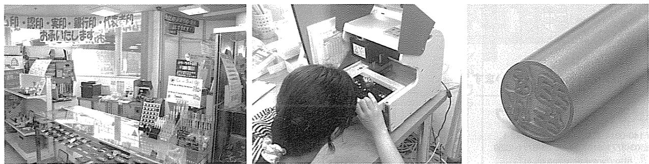
④印鑑関連コーナー。写真中央の奥に「BIZ50」を設置。⑤BIZ50に印材をセット。印材の高さ、直径の自動計測機能付きで初心者も扱いやすい。⑥BIZ50の彫刻サンプル。
