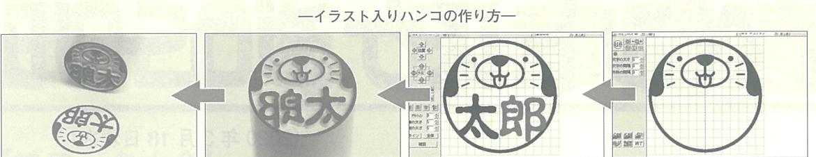
③彫刻して完成。ウイズアス製の「BIZ50」「TechnoEX」の他、ビットマップ形式に対応した他社製の彫刻機にも使用できる。
