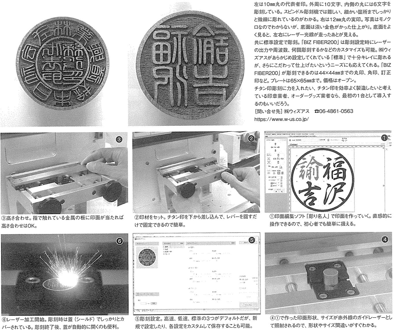
③高さ合わせ。指で触れている金属の板に印面が当たれば高さ合わせはOK。
